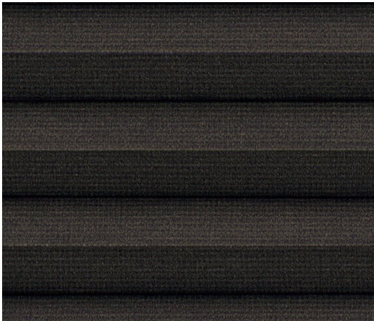
Vanessa 701594 lichtecht 4-5, Rückseite weiß Lichtundurchlässig blickdicht, Fc Wert 0.60 abbürstbar, feucht abwischbar Licht-Reflektion 66%, Licht-Absorption 34% Licht-Transmission 0% Waben innen mit Aluminiumbeschichtung
