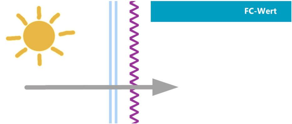
Der Fc-Wert steht für den Abminderungsfaktor einer Sonnenschutzanlage. Dieser liegt zwischen Null und Eins und ist abhängig von der Glasart. Je niedriger der Wert umso weniger Sonnenenergie trifft in das Rauminnere.
